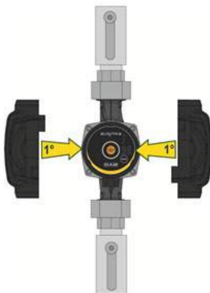
Afbeelding 7: Isolatie van het pomphuis
